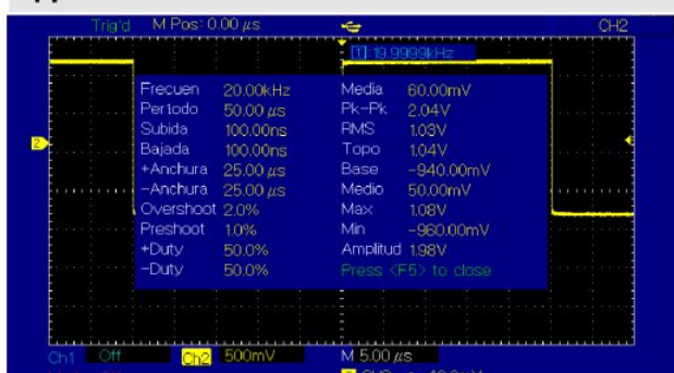
Multiple automatic parameter measurements
